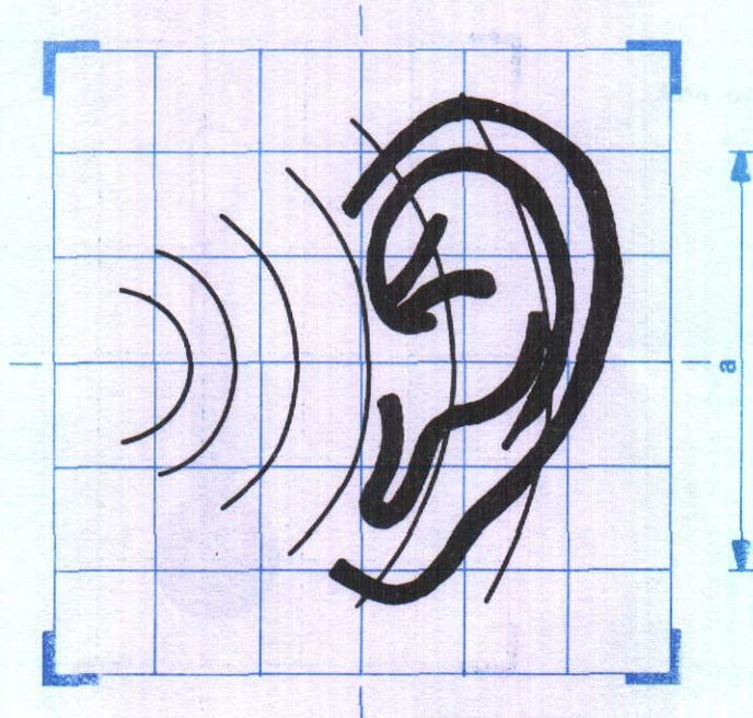
**Aplicaciones:** Sobre cualquier equipo o material. **Significado:** presencia actual o potencial de ruidos u ondas sonoras de intensidad dañina al oído humano. Usese especialmente en la señal de seguridad 2.13.
